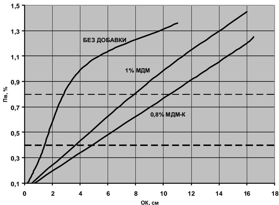
*Рис.1. Влияние добавок МДМ и МДМ-К на показатель водоотделения ( $P_v$ , %) бетонных смесей с расходом цемента  $180-200 \text{ кг/м}^3$  в зависимости от подвижности по осадке конуса ( $O_K$ , см) (пунктирные линии – предельные значения  $P_v$  по ГОСТ 7473-94: 0,4% - для смесей марки П1-П2; 0,8% - для смесей марки П3-П5).*
