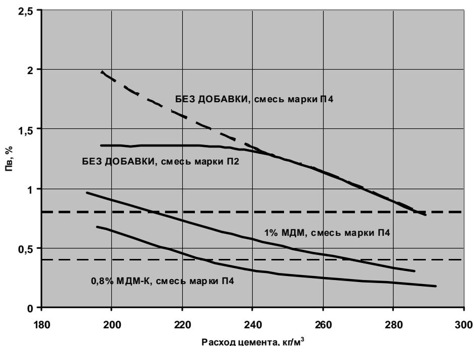
*Рис.2. Влияние добавок МДМ и МДМ-К на показатель водоотделения ( $P_v$ , %) бетонных смесей марки П4 в зависимости от расхода цемента (горизонтальные пунктирные линии – предельные значения  $P_v$  по ГОСТ 7473-94: 0,4% - для смесей марки П1-П2; 0,8% - для смесей марки П3-П5).*
